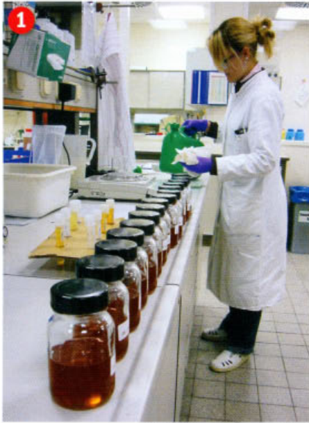
1) Der verkeimte Diesel wird in Mengen zu je 100 ml abgefüllt und dann mit je einer Prophylaxe- und einer Schockdosierung beimpft. 2) Unter dem Mikroskop sind Pilzkolonien zu erkennen. 3) So sieht ein verkeimter Tank von innen aus. Die braunen Placken sind Biomasse. 4) Nährböden am Ende des Tests. Dort, wo starker Bewuchs sichtbar ist, haben die Mittel nicht wie erhofft gewirkt
