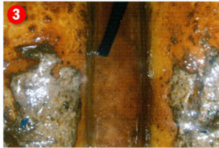
1) Der verkeimte Diesel wird in Mengen zu je 100 ml abgefüllt und dann mit je einer Prophylaxe- und einer Schockdosierung beimpft. 2) Unter dem Mikroskop sind Pilzkolonien zu erkennen. 3) So sieht ein verkeimter Tank von innen aus. Die braunen Placken sind Biomasse. 4) Nährböden am Ende des Tests. Dort, wo starker Bewuchs sichtbar ist, haben die Mittel nicht wie erhofft gewirkt
